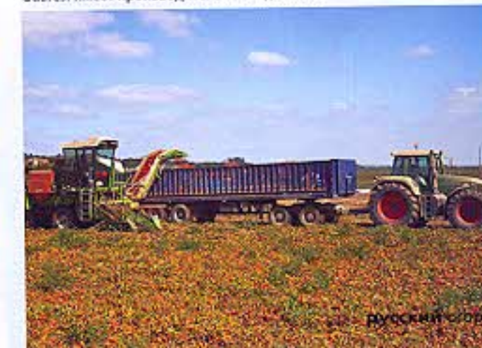
Современный высокопроизводительный томатоуборочный комбайн Guarsi имеет производительность до 20 т/ч
